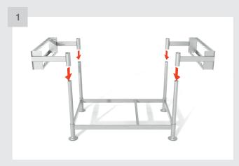
Setzen Sie die Erweiterung "Rohrauflage unten" auf die Rohre der Rohrpalette bis die Erweiterung unten aufsetzt.
