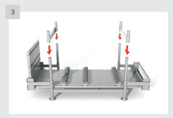
Setzen Sie die Erweiterung "Rohrauflagen Oben" auf die Rohre der Rohrpalette bis die Erweiterung oben aufsetzt.
