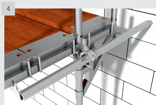
4 Befestigen Sie die Gerüstssicherung an der Öse und der Kupplung.
