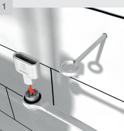
1 Stecken Sie die Ringösennuss in die passende Aufnahme der Gerüstbauratsche
