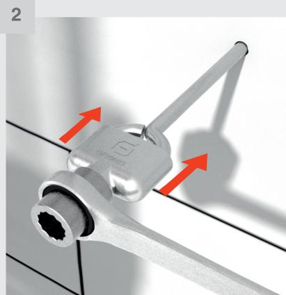
2 Führen Sie die Ringösennuss mit dem Schlitz auf die Ringösenschraube.
